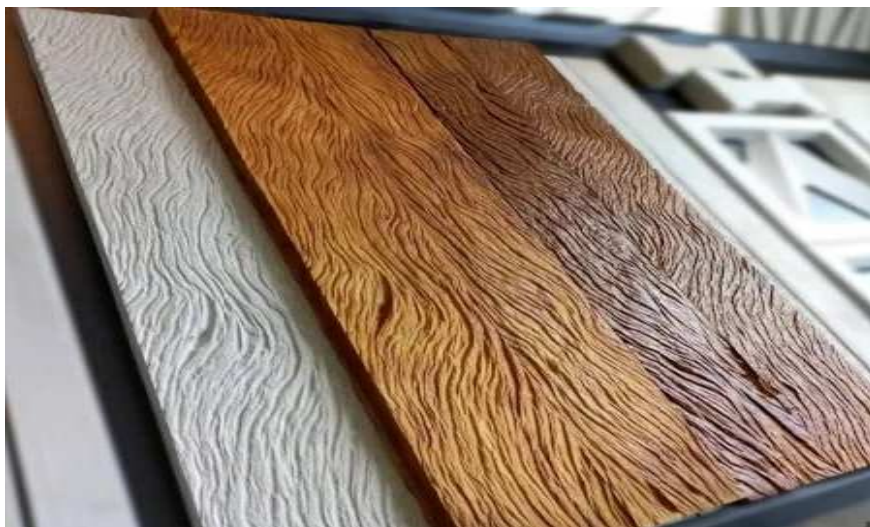
FIGURA 24. REVESTIMENTO COM APLICAÇÃO DA RESINA
